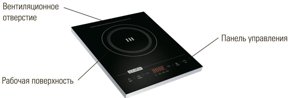
Работа индукционной плиты основана на принципе электромагнитной индукции. Электрический ток, проходя через катушку, преобразуется в переменное магнитное поле. Переменное магнитное поле способно порождать изменяющееся электрическое поле (индукционный ток). Обладающая ферромагнитными свойствами посуда представляет собой проводник с замкнутым контуром. Под воздействием вихревого индукционного тока электроны дна посуды приходят в движение, что приводит к выделению тепловой энергии
