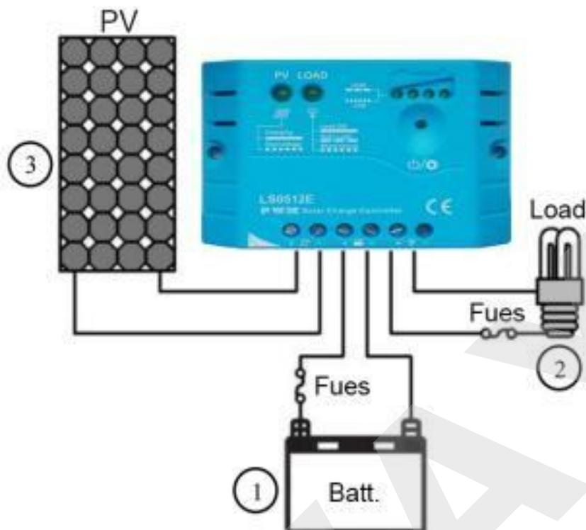
Осуществляйте подключение к контроллеру в соответствии с порядком, указанным на рисунке. Особое внимание обратите на полярность подключений “+” и “-”. Первым делом подключается аккумулятор.
