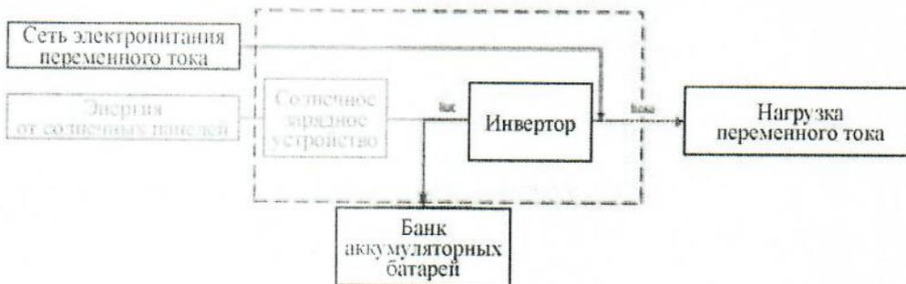
Аккумуляторная батарея заряжается от сети электропитания. Максимальное значение тока IUC составляет 30 А. Солнечное зарядное устройство не работает. Если выключатель питания ON/OFF (ВКЛ/ВЫКЛ) установлен в положение ON (ВКЛ), устройство подает питание на нагрузку. Если выключатель питания ON/OFF установлен в положение OFF (ВЫКЛ), устройство не будет подавать питание на нагрузку.
