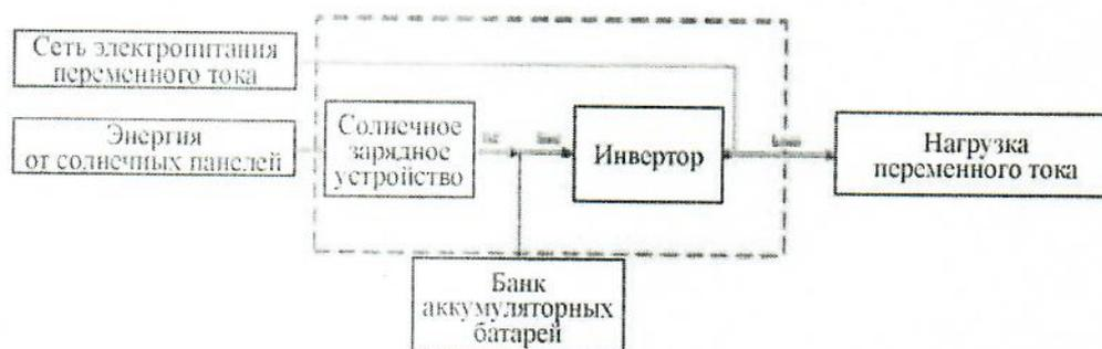
В этом режиме нагрузка питается от аккумуляторной батареи и от солнечных панелей. Если имеется солнечная энергия, работает солнечное зарядное устройство. Максимальное значение тока  $I_{SC}$  доходит до 50 А. Далее, состояние солнечной энергии и подключенной нагрузки определяет, будет аккумуляторная батарея заряжаться или разряжаться.
