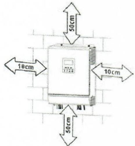
Установите устройство и закрепите его, завернув три шурупа, как показано на рисунке.
