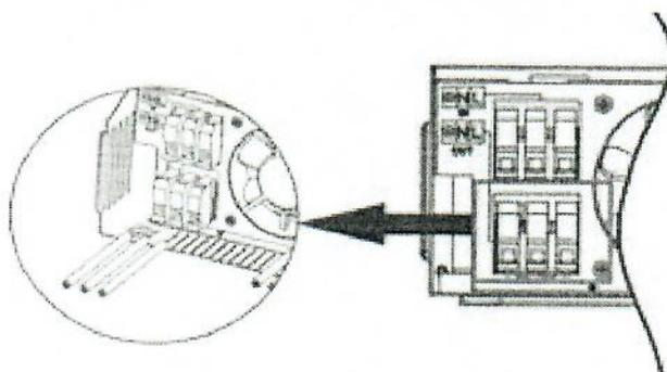
8. Проверить, надежно ли подключены провода.
