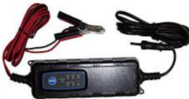
Герметичные, с классом защиты IP65 зарядные устройства Low Power Battery Charger выполнены в корпусе из ударопрочного пластика. Устройство имеет 4-х ступенчатую зарядную характеристику, пять светодиодов для индикации режимов работы и кнопку выбора одного из трех профилей заряда. Два уровня тока заряда выбирается пользователем 0,8 или 4А.
