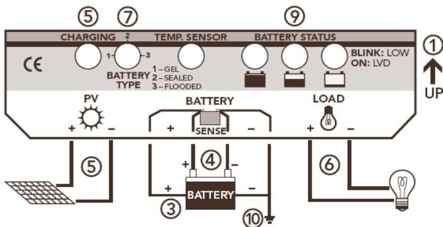
7. Задайте тип АКБ для правильного алгоритма заряда, для этого используйте отвертку. Индикатор статуса АКБ мигнет 1,2 или 3 раза в зависимости от заданного типа АКБ.
